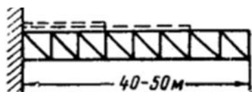
Рисунок 2 – Схема фермы с напряжением растянутого пояса [2]
