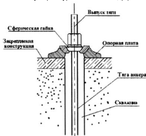
Рисунок 9 - Конструкция оголовка анкера [5]
